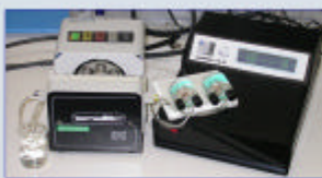
Fig.1 Libra 3 Nanogravimetric DNA-sensor
